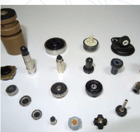
ゴム焼き付け
