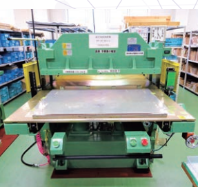
大径1000mm/m角まで対応のプレス機
