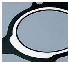
レーザー塗膜除去
