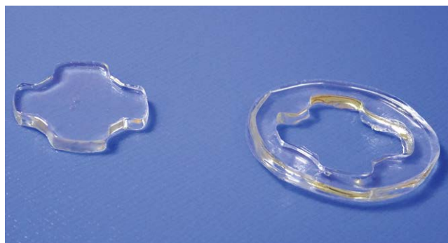
左：シリコンゴムカップにゲル注型 右：ゲルシートの打ち抜き
